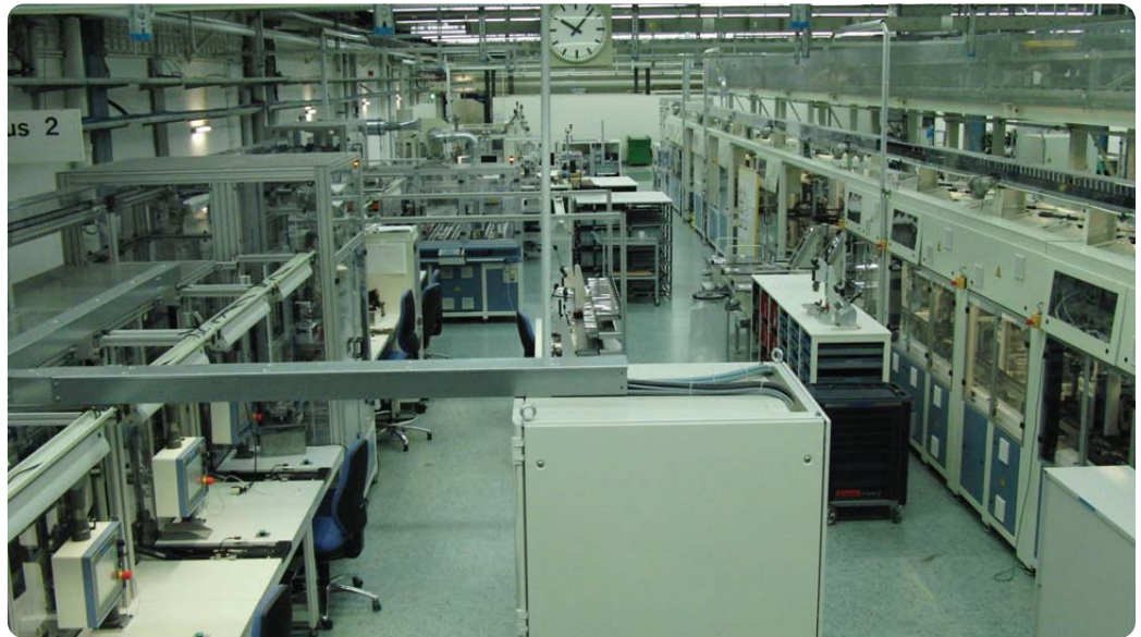
Bild 2: Die Montagelinie mit integrierten Prüf- und Sondermontageplätzen gewährleistet 100% geprüfte Qualität für über 1.500 bestellbare Schützvarianten.
