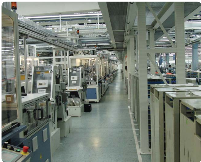
Bild 3: Im Auslauf der Linie werden die zu einem Auftrag gehörenden Schütze in einer großen Verteilerharfe gesammelt. Dies ist nicht nur zur Entkopplung der Verpackungs- und Versandprozesse von der Produktion nötig, sondern auch, weil im Auslauf der Linie die Reihenfolge der Schütze aufgrund verschiedener Wege durch die Montage eine andere sein kann als die Reihenfolge beim Produktionsstart.
