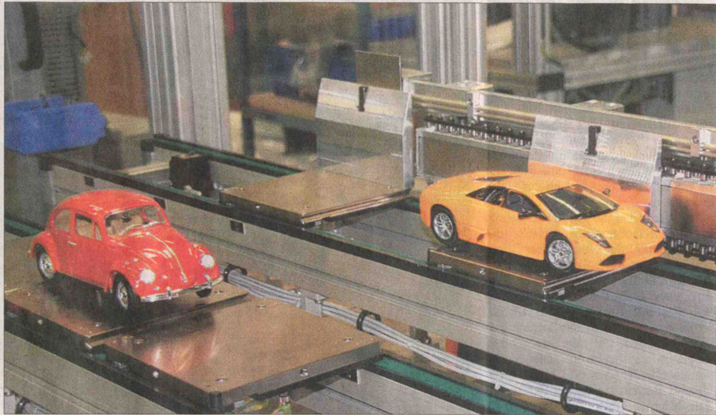
Nicht nur schneller, sondern auch genauer: Der Sportwagen steht auf dem neuen Magnet-System von Strama und der Käfer auf einem üblichen Förderband. (Foto: hal)
